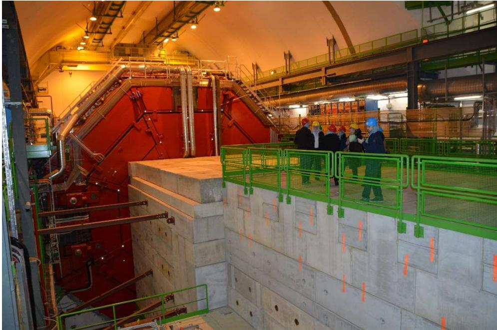
Plateforme située à l'autre extrémité d'ALICE : les portes de l'aimant solénoïde (en rouge) sont fermées. Le détecteur est prêt à recevoir les faisceaux.
