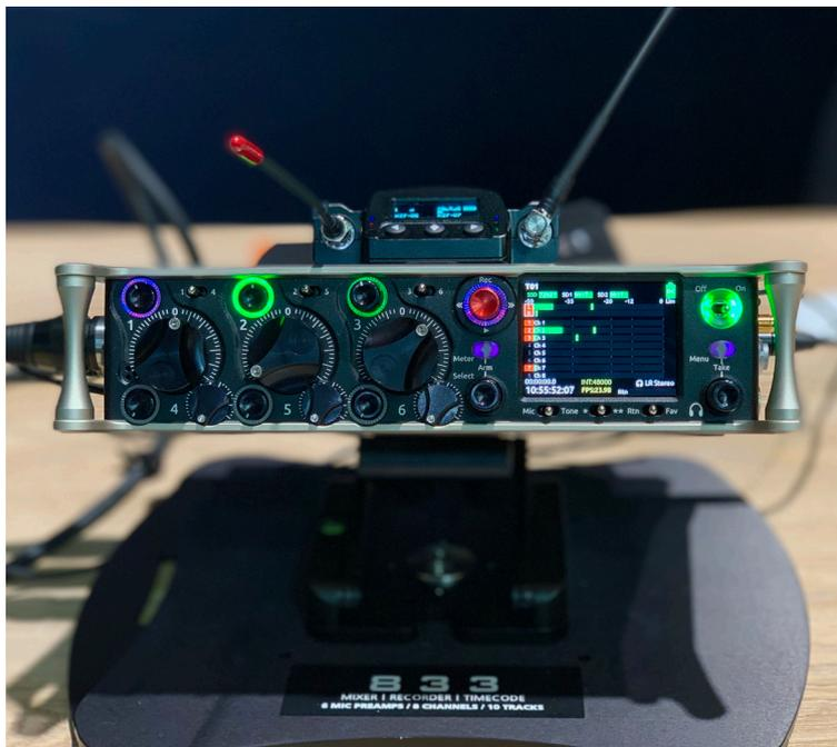
Après la sortie du Scorpio au deuxième trimestre 2019, Sound Devices lance la production du 833. Largement basé sur le 633 en terme d'ergonomie et de volume, le 833 représente un pas en avant dans de nombreux domaines, à la fois en terme de qualité sonore et de confort d'utilisation. Les préamplis sont identiques à ceux du Scorpio et sont désormais au nombre de 6, avec 48V, limiteurs et un égaliseur par canal que l'on peut router pré ou post-fader.
