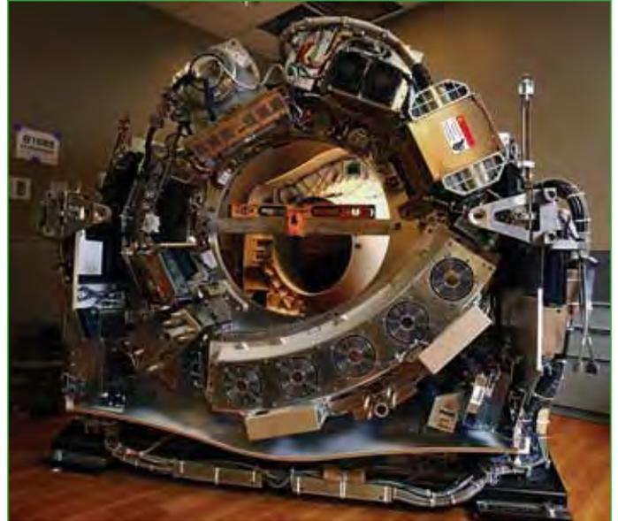
Fig. 7 : Photographie d'un scanner à rayons X actuel constitué d'un tube à rayons X (en haut à gauche), du berceau de détecteurs (en bas), des alimentations et des systèmes de refroidissement, le tout monté sur un rotateur muni de collecteurs tournants.
