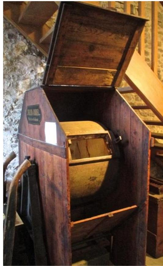
La poudre de safran est obtenue en pulvérisant les stigmates de safran au broyeur à galets.
