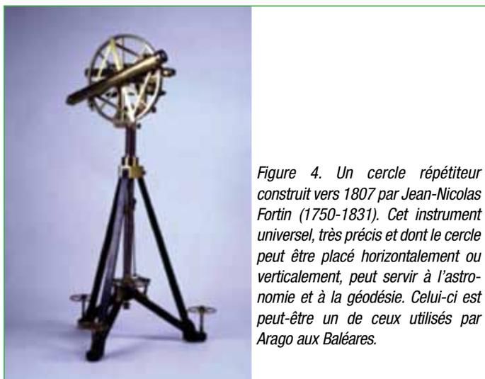
Figure 4. Un cercle répéteur construit vers 1807 par Jean-Nicolas Fortin (1750-1831). Cet instrument universel, très précis et dont le cercle peut être placé horizontalement ou verticalement, peut servir à l'astronomie et à la géodésie. Celui-ci est peut-être un de ceux utilisés par Arago aux Baléares.
