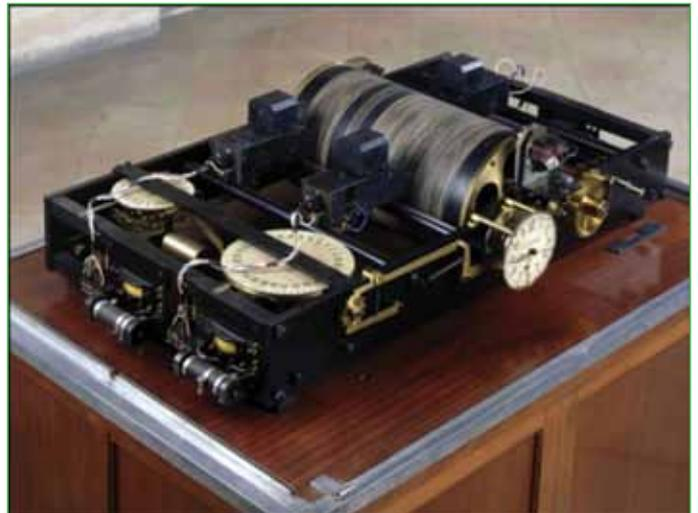
Figure 7. La première horloge parlante, construite en 1933 par les Établissements Brillé. Elle a été suivie de plusieurs autres réalisations à base d'électronique.
